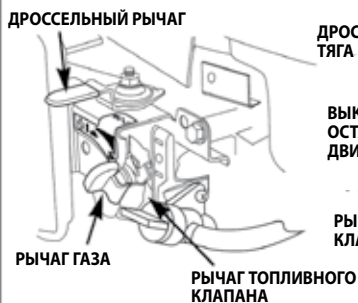
ТИП 3: ТОРМОЗ МАХОВИКА/ ДИСТАНЦИОННЫЙ ДРОССЕЛЬ/ ФИКСИРОВАННЫЙ ГАЗ
