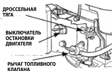
ТИП 5: МЕХАНИЧЕСКИЙ ДРОССЕЛЬ/ ФИКСИРОВАННЫЙ ГАЗ
